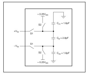
FIGURE 1. ADS1251, ADS1253, and ADS1254 Simplified Input Circuit.
