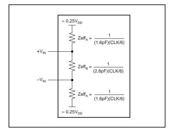
FIGURE 4. Effective Input Impedances of the ADS1251, ADS1253, and ADS1254.
