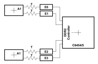
Figure 7. DQS and DQ Routing and Toplogy
