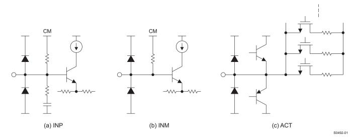
Figure 76. Equivalent Circuits of LNA inputs
