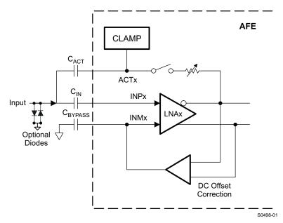
Figure 82. LNA Input Configurations
