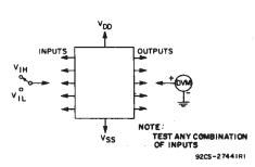
Fig. 13-Input-voltage test circuit.
