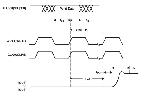
Figure 16. Dual-Bus-Mode Operation
