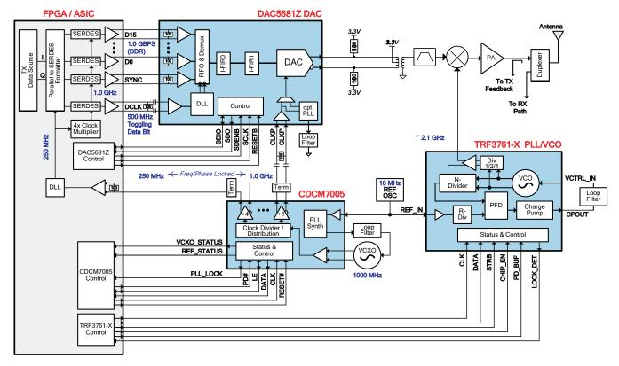
Figure 28. Example Real If System Diagram
