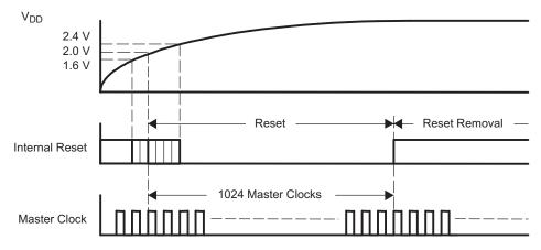
Figure 11. Power-On Reset Timing
