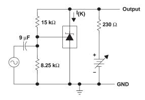
**TEST CIRCUIT FOR VOLTAGE AMPLIFICATION**
