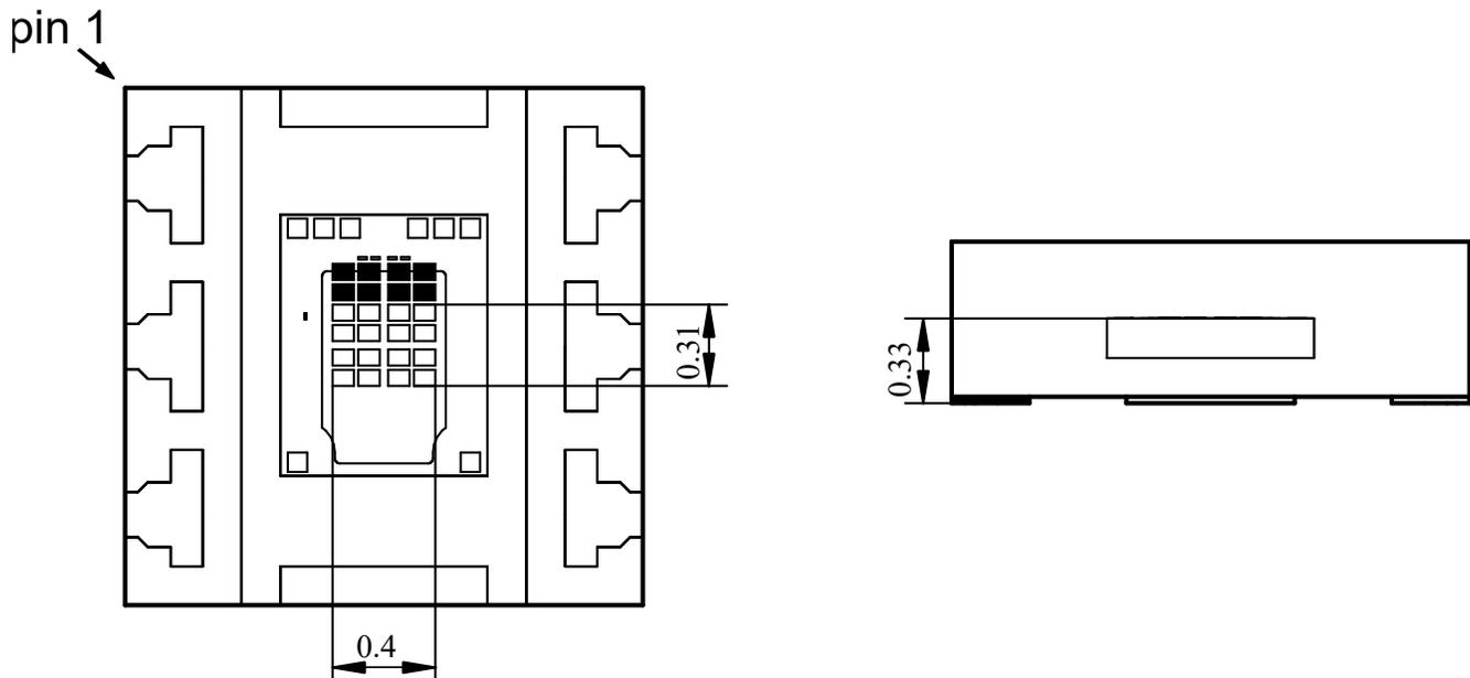
**Figure 8-2. Sensor Position**
