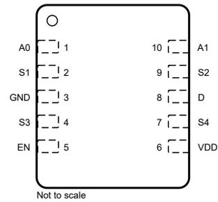
**Figure 4-2. DQA Package, 10-Pin USON (Top View)**
