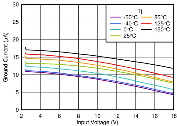
Figure 7-9.  $I_{GND}$  vs  $V_{IN}$
