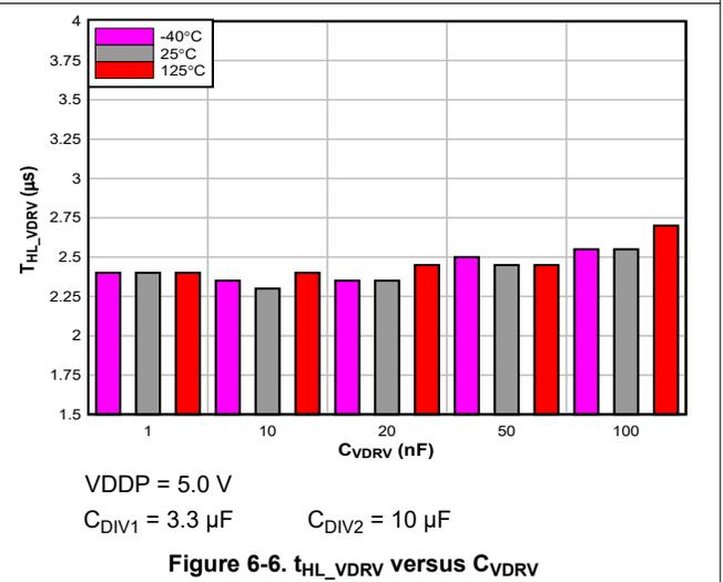
Figure 6-6. t<sub>HL\_VDRV</sub> versus C<sub>VDRV</sub>
