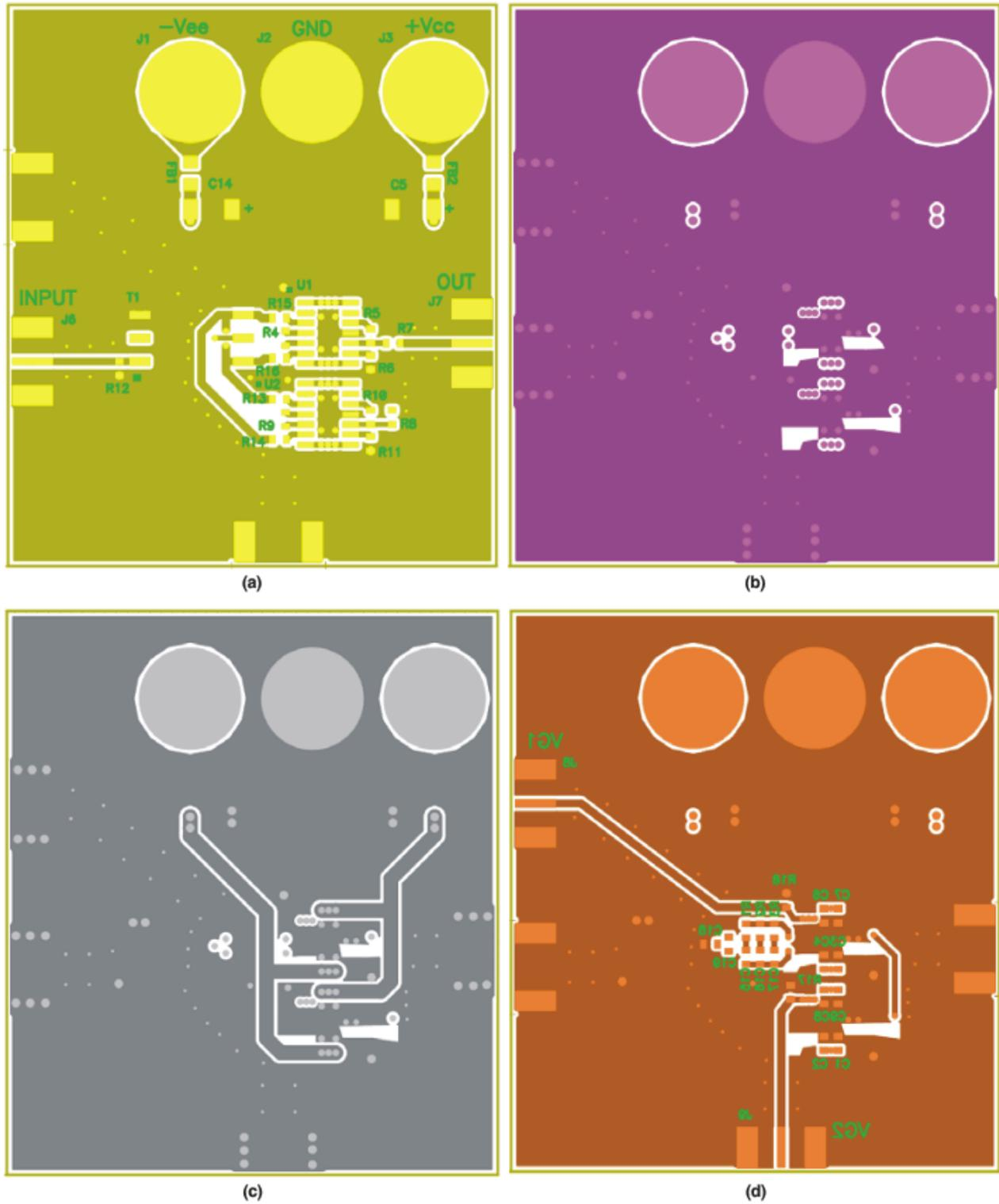
Figure 6. Evaluation Board Layout (Top View): (a) Top Layer, (b) Mid Layer 1; (c) Mid Layer 2; (d) Bottom Layer
