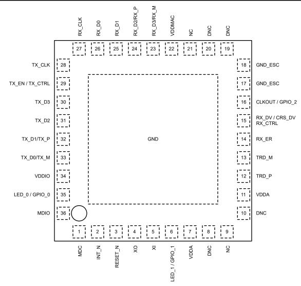
Figure 4-1. DP83TC814S-Q1 RHA Package 36-Pin VQFN
