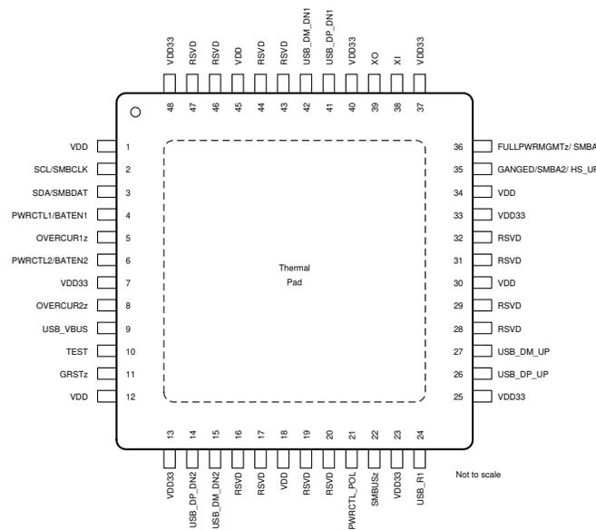
**Figure 4-1. Pin Diagram**
