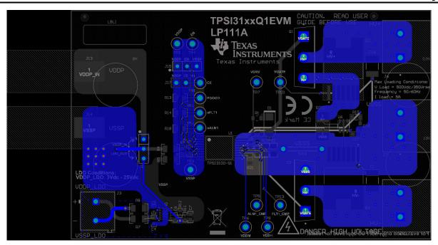
Figure 3-6. PCB Bottom Layer
