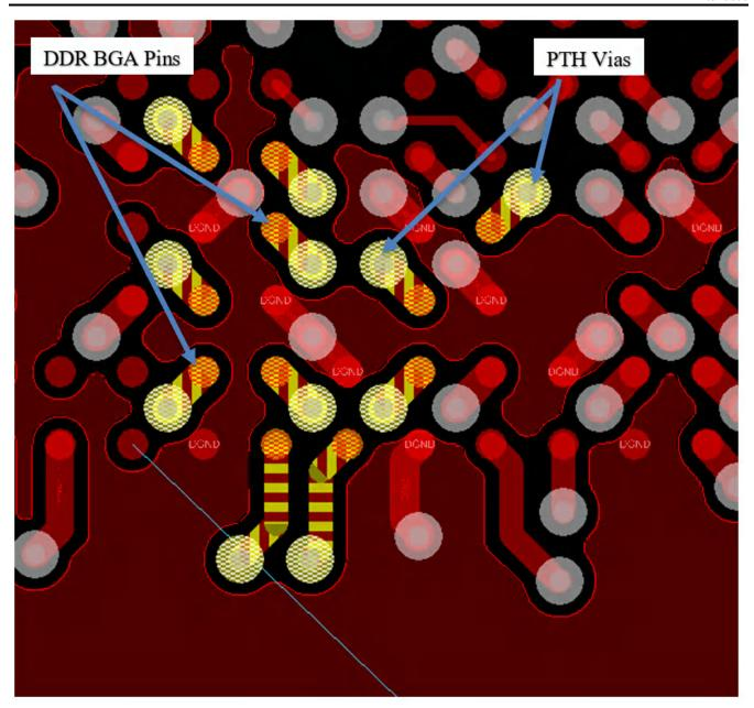
Figure 10-3. DDR Data Byte Lane 2 Escape
