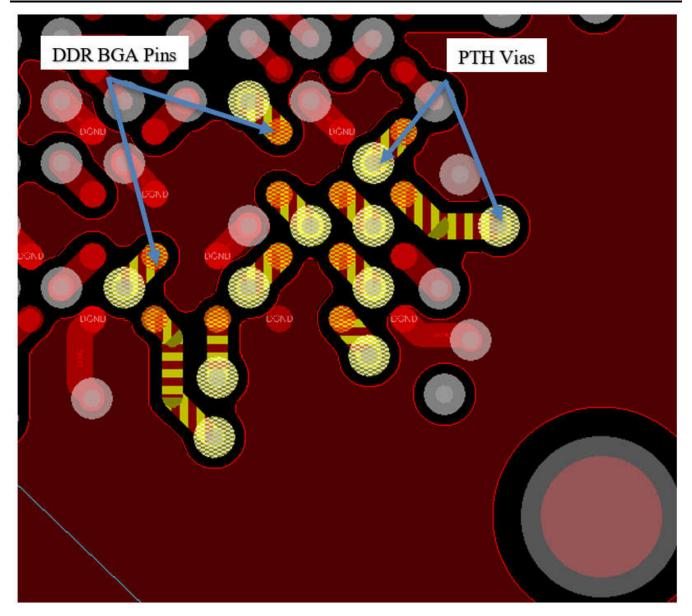
Figure 10-4. DDR Data Byte Lane 3 Escape
