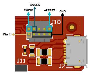
Figure 2-4. ARM 10 pin JTAG Connector (J10)
