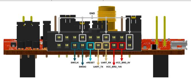
Figure 2-5. 20 pin LP-XDS110 Connector (J11)
