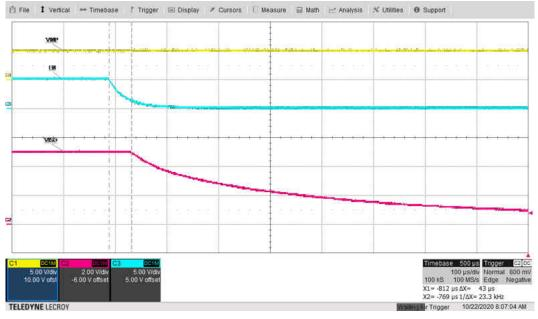
Figure 5-1. CH1: V<sub>INP</sub>, CH2: EN, CH3, V<sub>ISO</sub> (5 V)
