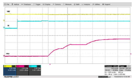
Figure 4-1. CH1: V<sub>INP</sub>, CH2: EN, CH3: V<sub>ISO</sub> (5 V)
