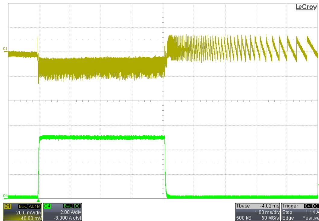
**11 5V Flyback Switching Waveforms**
