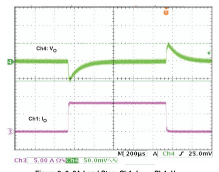
Figure 9. 0-8A Load Step, Ch1: I<sub>OUT</sub>; Ch4: V<sub>OUT</sub>
