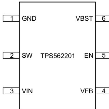
**Figure 4-1. 6-Pin SOT DDC Package (Top View)**
