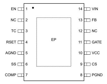
Figure 4-1. Pin Diagram
