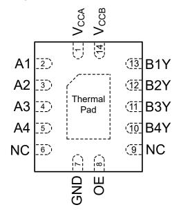
Figure 4-2. Pin Diagram (VQFN-14 Package)
