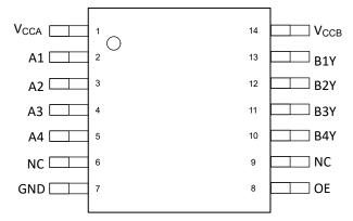
Figure 4-1. Pin Diagram (TSSOP-14) Package
