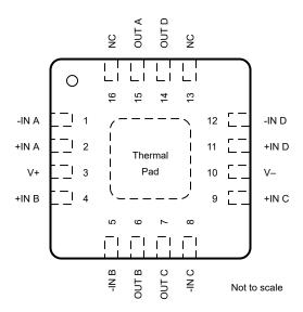
Figure 4-1. Pin Diagram
