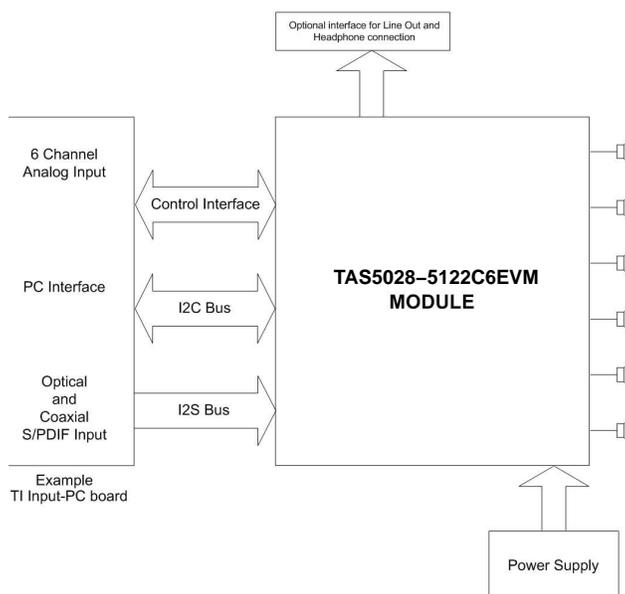
Figure 1-1. Complete PurePath Digital™ System
