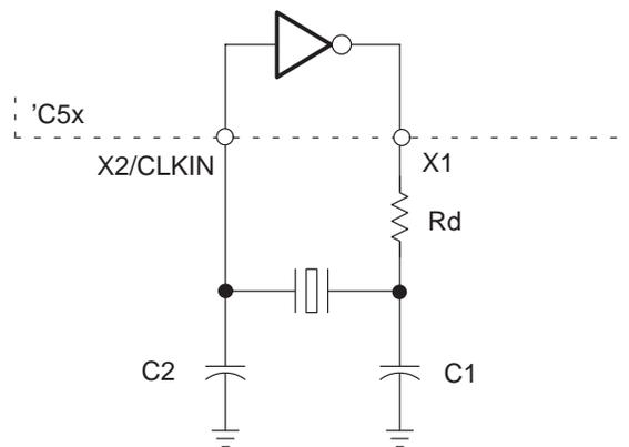
Figure 20. Fundamental-Mode Circuit
