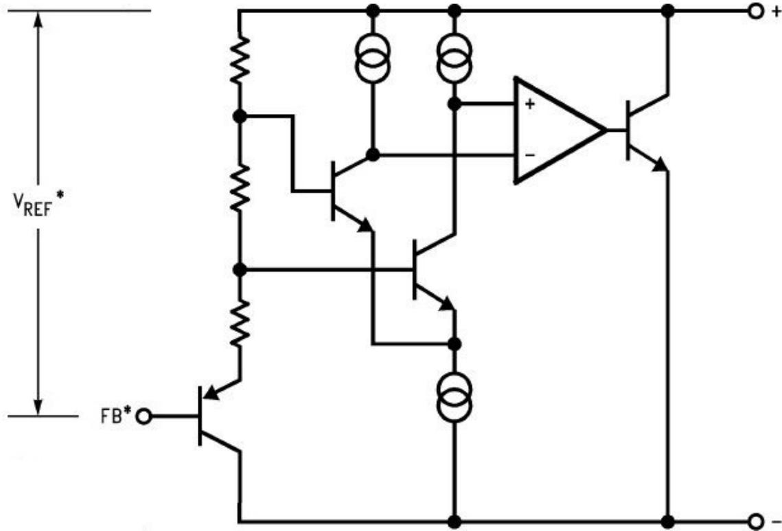
**Figure 4. LM4041-N Block Diagram**
